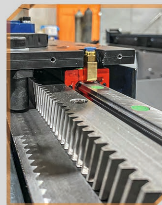
Рельсовые направляющие и каретки с преднатягом HIWIN
