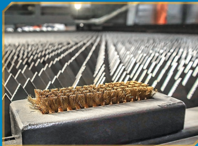
ФУНКЦИЯ АВТОМАТИЧЕСКОЙ ОЧИСТКИ СОПЛА
