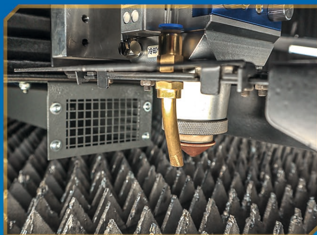
ДОПОЛНИТЕЛЬНОЕ ОХЛАЖДЕНИЕ ЗАГОТОВКИ В ЗОНЕ РЕЗА
