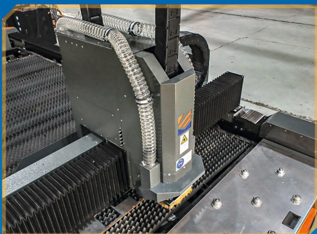
СИСТЕМА ВЕРХНЕГО ДЫМОУДАЛЕНИЯ ИЗ ЗОНЫ РЕЗА
