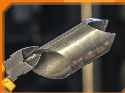
Деталь, вырезанная из круглой трубы
